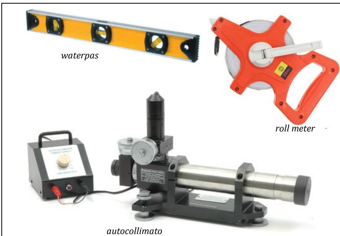
Gambar 1. 2 Alat Ukur Panjang Untuk Pembangunan Gedung
